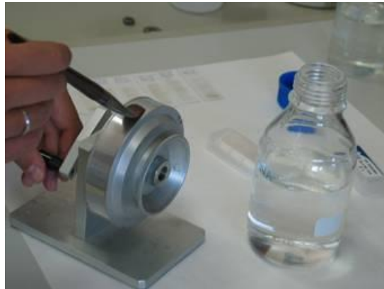
Imagen 1. Aplicación del fluido adherente sobre la cinta de Melinex dispuesta sobre el tambor. (Galán et al. 2007)
